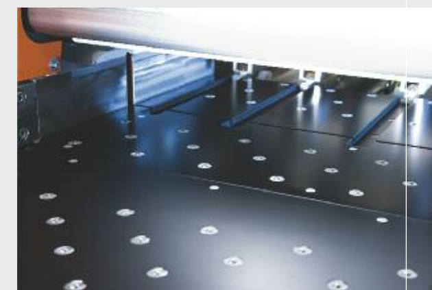
Coussins d'air dans la table de machine afin de protéger les décors de panneaux fragiles.
