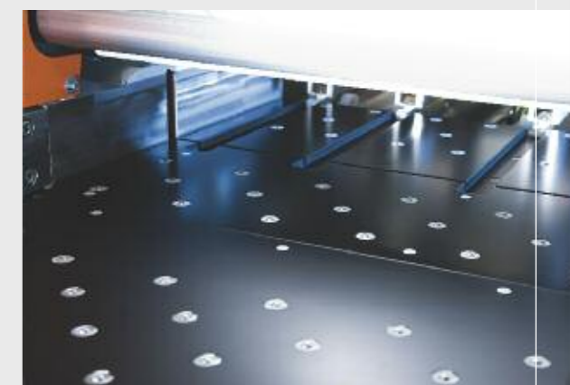
Cuscini d'aria nel piano della macchina per la protezione delle decorazioni delicate dei pannelli.
