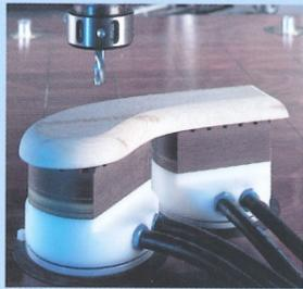
Sicheren Halt auch bei komplizierten Formen bietet der Schmalteile-Sauger
