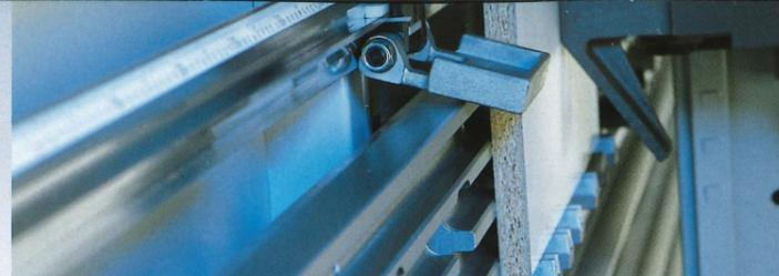
Durchgängige untere Werkstückauflage bis an die Schnittlinie. Vertikale, schmale Teile können nicht kippen oder nach unten durchfallen. Die Anlageleisten aus Kunst-
