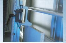
Der Streifenanschlag sorgt für einen gleichmäßigen Zuschnitt auf Breite der Werkstücke, d.h. einmal eingestellt immer gleich gesägt.
