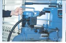
Ausgelegt für Vertikal- und Horizontalschnitte. Letztere sind dabei in jeder Position möglich. Ein großzügig dimensionierter Hebel
