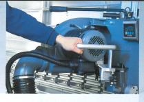
Balken über gewünschte Schnittposition schieben – der Sägebalken rastet exakt ein.
