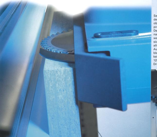
Selbst das Eintauchen des Sägeaggregats in oberster Position ist problemlos möglich. Der Hebel kann einfach nach unten geschwenkt werden. Dadurch sichere Führung in allen Arbeitspositionen. Außerdem: die flexiblen Einsatzmöglichkeiten. Denn die PK 1255 arbeitet ohne Druckluftunterstützung.
