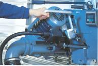
ermöglicht ein problemloses Schwenken des Aggregates. Die Fixierung des Sägebalkens mit einer Hand auf "verriegeln" stellen –
