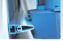
Der automatisch ausweichende Anlagerost verhindert das Zerschneiden der Anlageleisten beim Horizontalschnitt.
