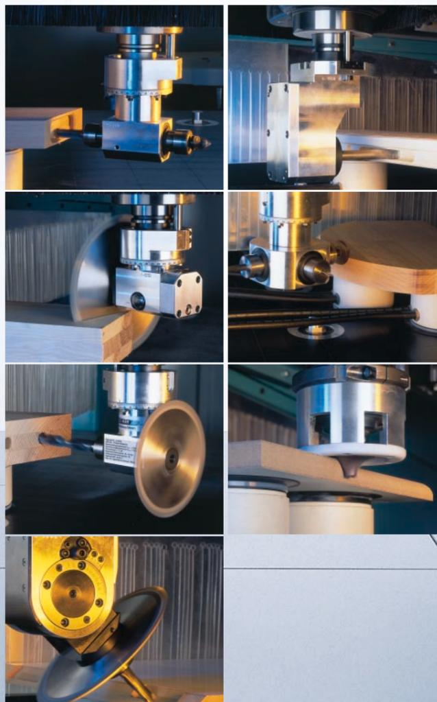
**Winkelkopf/Schlosskastenfräsaggregat.** Ein Ausgang für Werkzeugschaft ø = 16 mm; n (max.) = 12000 min<sup>-1</sup>.
