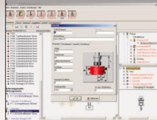
Über das Register des Toolmanagers können alle Werkzeuge und Aggregate dargestellt werden. Das Werkzeug wird anschließend am Bildschirm auf seiner Bearbeitungsposition abgelegt. Dabei zeigt der Toolmanager alle Parameter der einzelnen Werkzeuge sowie ihre Schnittdaten auf.
