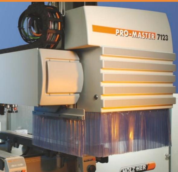
Die Steifigkeit des Fahrständers der PRO-MASTER wurde mit der „Finite Elemente Berechnung“ optimiert. Sie erlaubt eine hohe Belastung bei geringem Gewicht. Dies ermöglicht extreme Beschleunigungswerte und eine besondere Dynamik.
