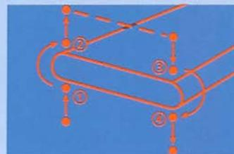
Das Kopierfräsaggregat 1983 übernimmt das Kappen und bearbeitet in einem Durchgang die stirnseitigen Kanten sowie die vier Eckpunkte (nur bei 1411-1 und 1412-1).
