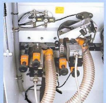
Den Wechsel zwischen mehreren Profilformen ohne Werkzeugwechsel bietet das Multifunktionsfräsaggregat 1942 M.
