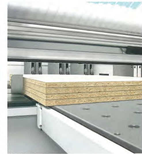
Zentrale Winkelandrückvorrichtung mit stufenlos einstellbarem Druck. Drückt direkt im Schnittspalt, genau dort, wo der Druck erforderlich ist.
