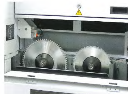
Bedienerfreundlicher Sägewagen, schneller Wechsel von Haupt- und Vorritzsäge. Compact saw carriage, quick change of main saw and scoring saw. Changement des lames de scies pour scie principal et inciseur facile et rapide.
