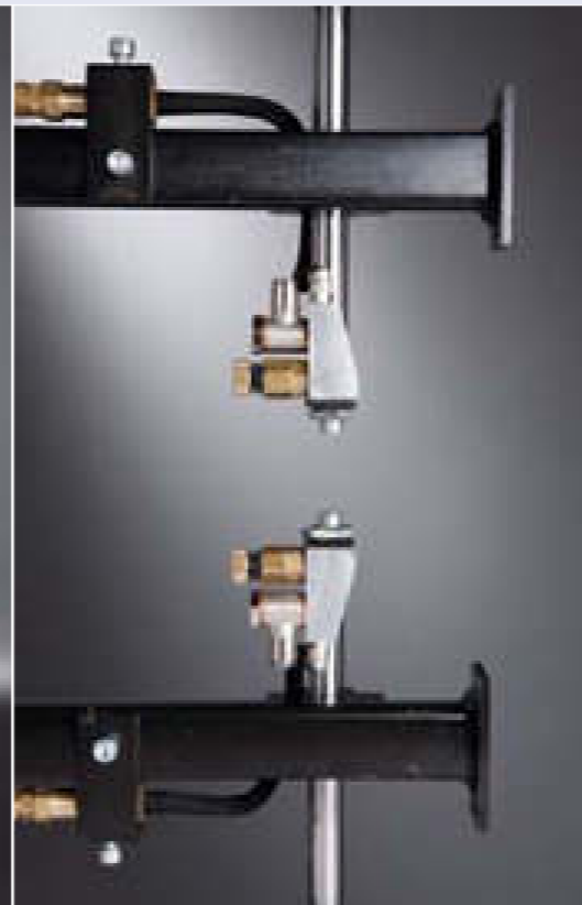
Reinigungsmittelauftrag Sprüheinheit zum Auftragen von Reinigungsmittel oben und unten auf das Werkstück. Aufbau vor dem Schwabbelaggregat.
