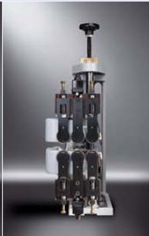
Finishbearbeitung FA10 Bestehend aus Leimfugenziehklinge zur Leimrestentsorgung oben und unten auf das Werkstück. Aufbau vor dem Schwabbelaggregat.
