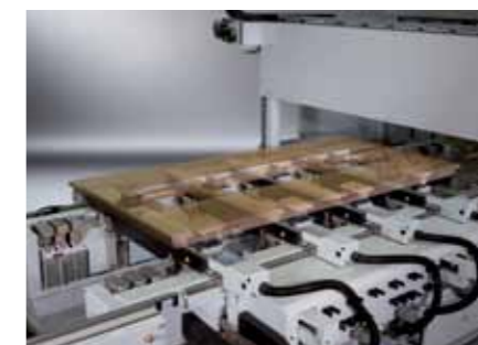
Die universellen Spannsysteme können simultan eingesetzt werden – z. B. für die Haustüren oder Rundbogenfertigung.
