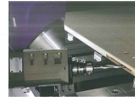
DRIVE5C+ Fünf-Achs-Spindel für weniger Aggregate und mehr Flexibilität bei der Gestaltung Ihrer Produkte.
