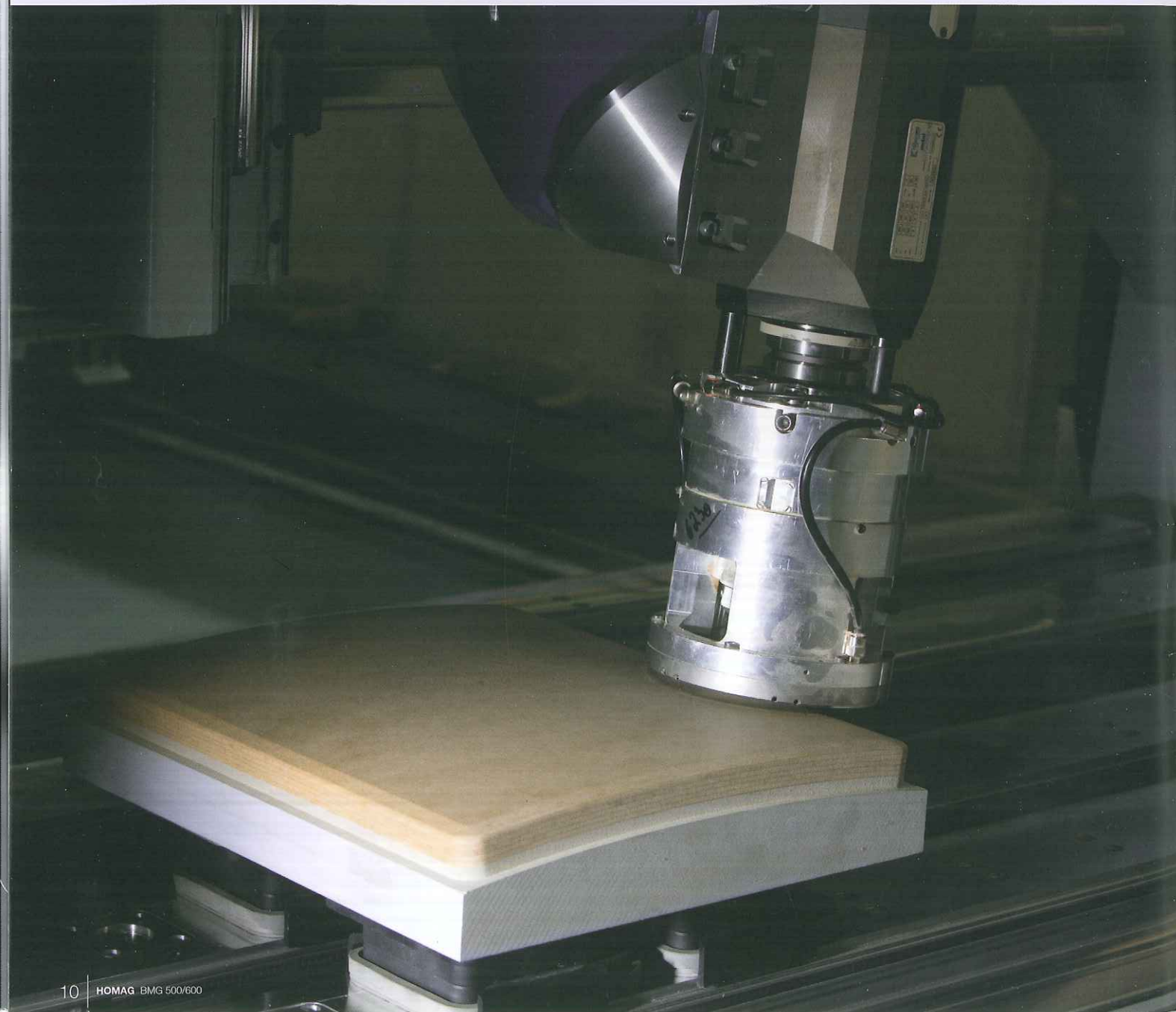
Getastetes Fräsen von gewölbten Möbelfronten mit DRIVE5C+ Fünf-Achs-Spindel
