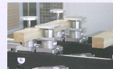
Automatisches Umspannen für eine 5-seitige Bearbeitung von Fenster- und Haustürkanteln.
