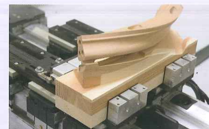
Horizontale Pneumatikspanner für die sichere Fixierung von Handlaufkrümmungen.
