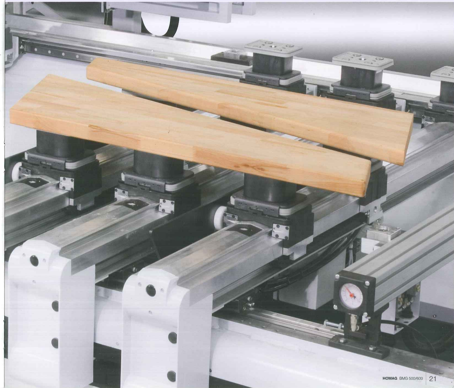
Automatisches Auftrennen und Auseinanderfahren von Treppenstufen für die umlaufende Komplettbearbeitung.
