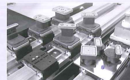
Unterschiedliche Vakuum- und Pneumatikspannelemente garantieren eine exakte Bearbeitung unterschiedlicher Werkstücke und Werkstoffe.
