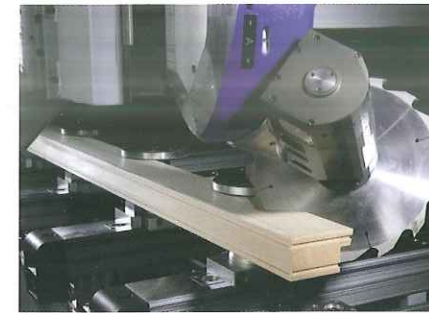
Exakte Schifterschnitte – passgenau auf Anrieb auch bei großen Materialstärken.
