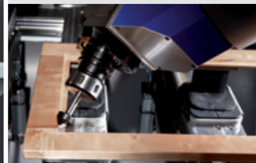
Eckiges Ausspitzen einer Glasfalz-Ecke
