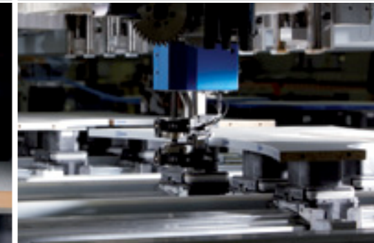
Perfektes Kantenfinish durch getastetes Kombi-Bündigräs-/Nachputzaggregat
