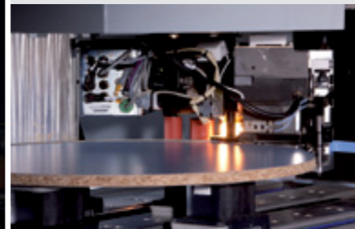
360° Kantenverleimung mit dem powerEdge Kantenanleimaggregat
