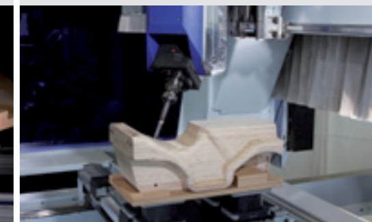
Interpolierende Bearbeitung von Freiformteilen
