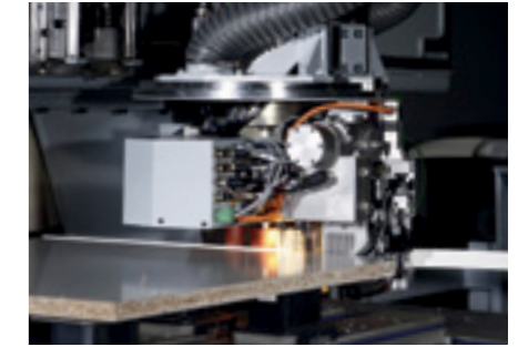
Kantenanleimen in bisher nie dagewesener Qualität: HOMAG laser Tec – der Quantensprung in der Möbelfertigung.
