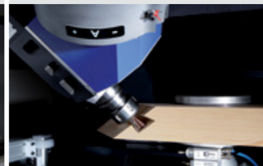
Fräsen einer Gratverbindung für Pfosten-/Riegelkonstruktionen
