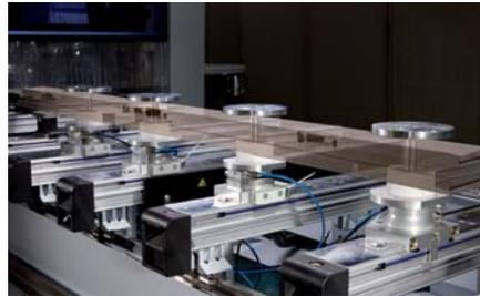
Manuelle Spannvorrichtung **powerClamp** für gerade und geschweifte Teile. Ideal für den Fensterbau
