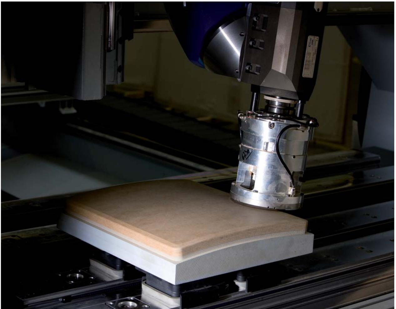
Getastetes Fräsen von gewölbten Möbelfronten mit DRIVE5C+ Fünf-Achs-Spindel
