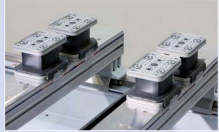
LED-System – wohl das schnellste und sicherste Positioniersystem für Konsole und Spannelemente (patentiert)
