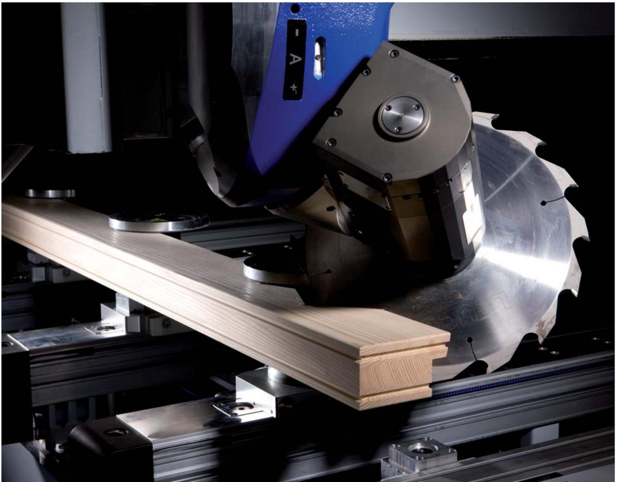
Mit einem maximalen Sägeblattdurchmesser von 350 mm sind auch exakte Schifterschnitte beim Wintergartenbau kein Problem
