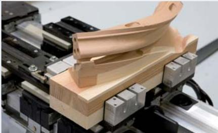
Horizontale Pneumatikspanner für die sichere Fixierung von Handlaufkrümmlingen
