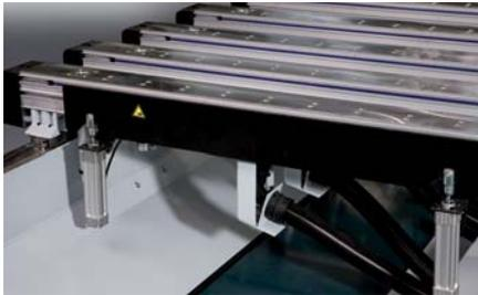
Abhubschienen mit zwei Pneumatikzylindern für das leichte Auflegen schwerer Werkstücke
