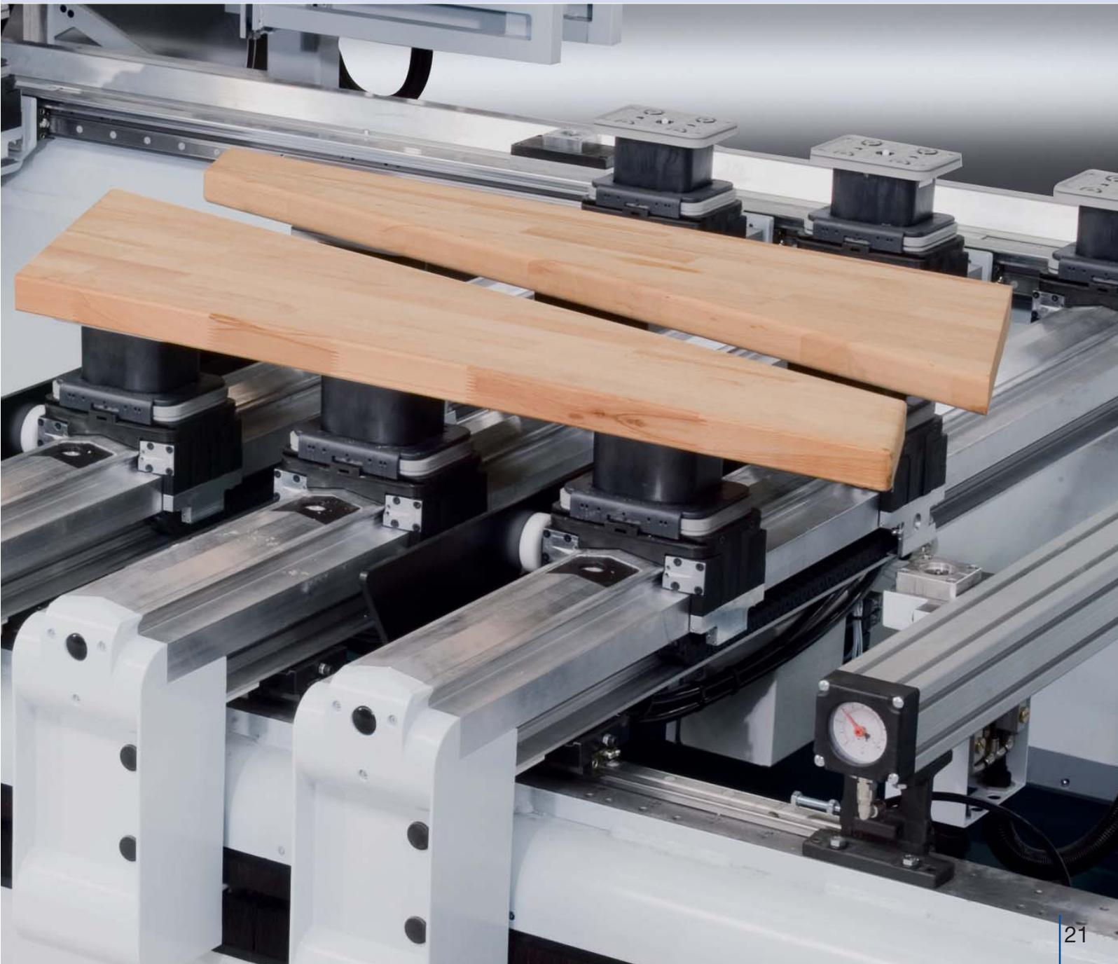
Vakuumspanner und Dichtschnüre zum flexiblen Aufspannen der Werkstücke
