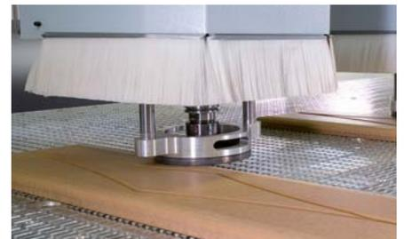
Getastetes Fräsen von Möbelfronten mit elektronischem sensoFlex-Tastsystem
