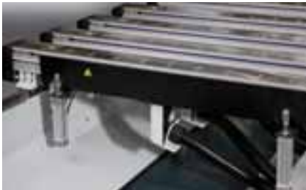
Rails équipés de deux vérins pneumatiques pour la dépose aisée de pièces de grande dimension
