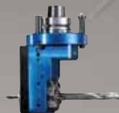
Agrégat pour la découpe de logements de serrures
