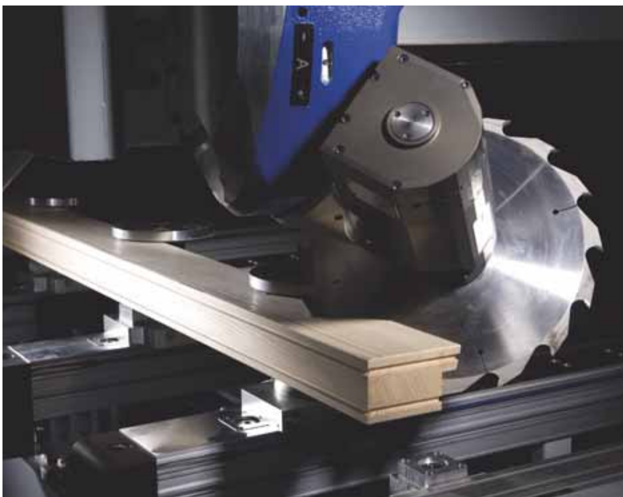
Des coupes en biais précises pour la construction de vérandas peuvent être réalisées aisément avec un diamètre de lame de scie maximal de 350 mm
