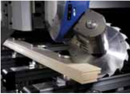
Coupes en biais précises d'emblée même pour les matériaux de grande épaisseur
