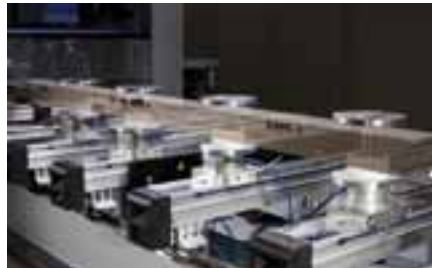
Dispositif de serrage manuel powerClamp pour les pièces droites et cintrées. Idéal pour la fabrication de fenêtres
