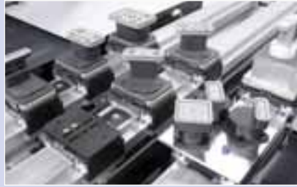
Serrage circulaire automatique pour un usinage de pièces de fenêtres et de portes sur 5 côtés
