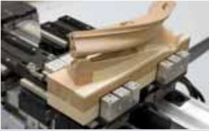
Élément de serrage horizontal pour la fixation fiable de limons de mains courantes
