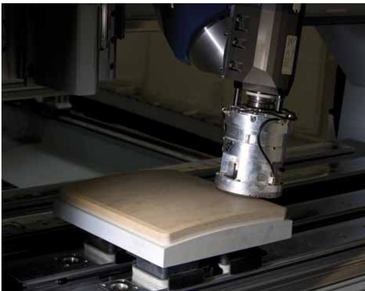
Fraisage palpé de façades de meubles cintrées avec la broche 5 axes DRIVE5C+
