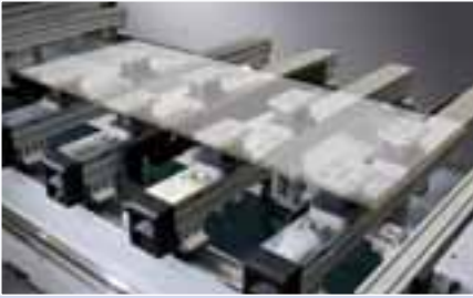
Le système de serrage „Maxi-Flex“ génère une surface continue pour un positionnement libre des éléments de serrage
