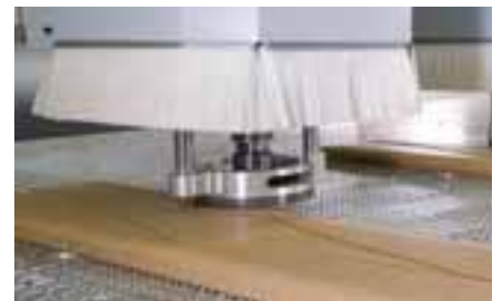
Fraisage palpé de façades de meubles par le système de palpage électronique sensoFlex
