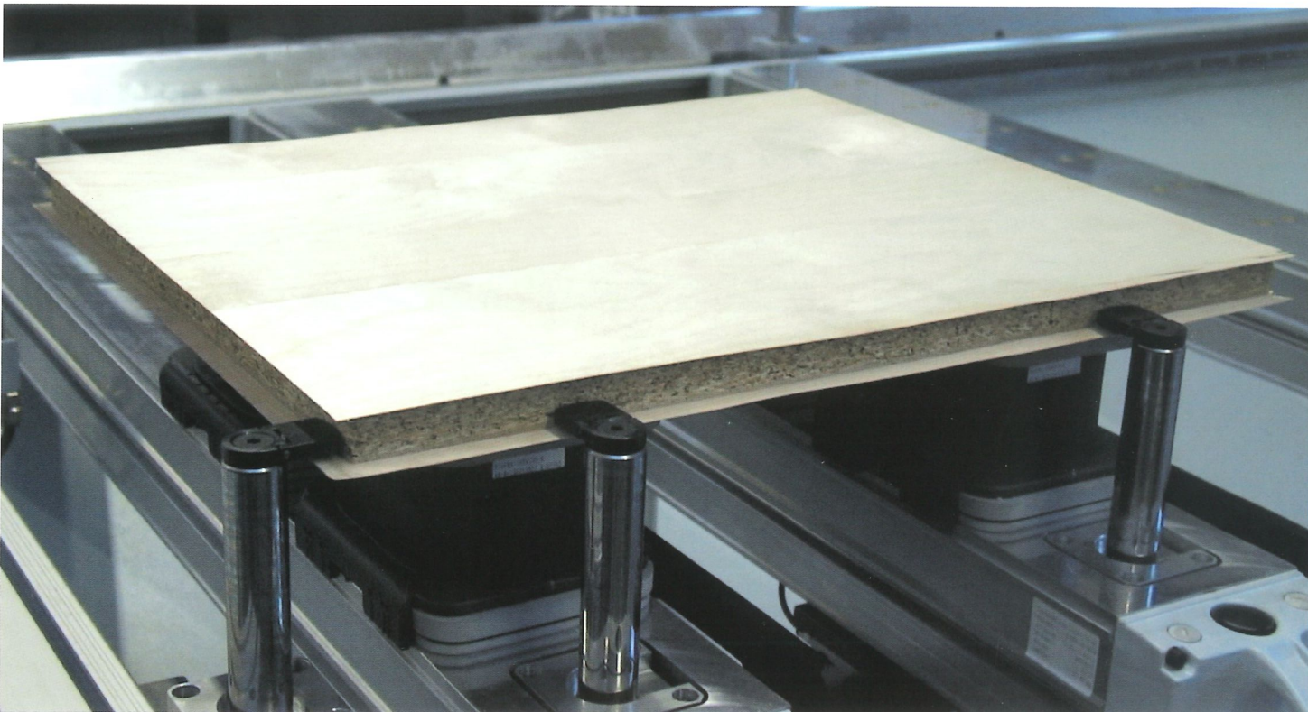
Anschlagbolzen mit einer integrierten Hub-Dreheinrichtung für Werkstücke mit überstehenden Deckschichten (z.B. Furnier). Alternativ können Aufsteckhülsen verwendet werden.
