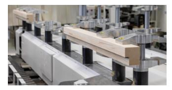
Hohe Leistung durch den 4,2 m-Aufspanntisch mit Doppelbelegung bis 1,9 m. Dadurch 2 Teile gleichzeitig in Bearbeitung.
