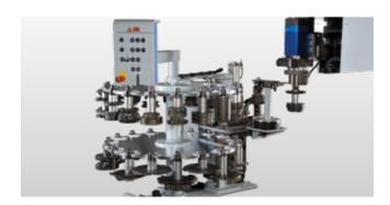
Flexibles Werkzeugwechselsystem: Alle Werkzeuge in direktem Zugriff ohne Umrüsten und Umsortieren, mit kurzen Wechselzeiten durch Vorwechselsystem mit Umgreifer.
