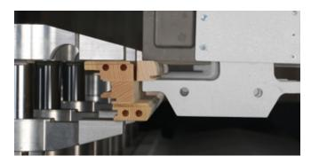
Entnahme von Glasleisten mit der Möglichkeit zum Finish fräsen im Glasfalz. Keine zusätzliche Bearbeitung erforderlich. Flügelteil und Glasleiste bleiben immer zusammen. (Option)
