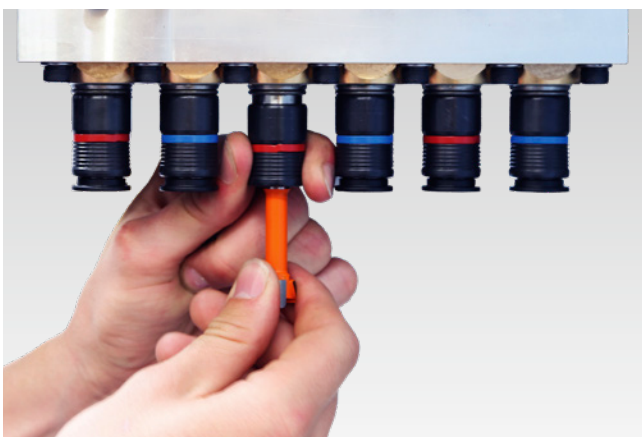
Système de changement rapide breveté pour un changement de mèche sans outils afin de réduire les temps de réglage.
