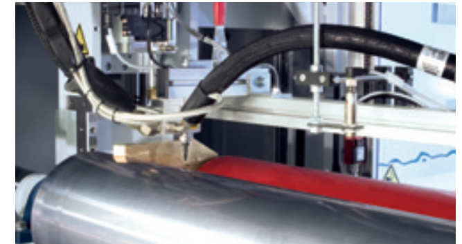
Dosier- und Auftragswalze mit speziellem Dichtbackensystem für eine effiziente und saubere Produktion
