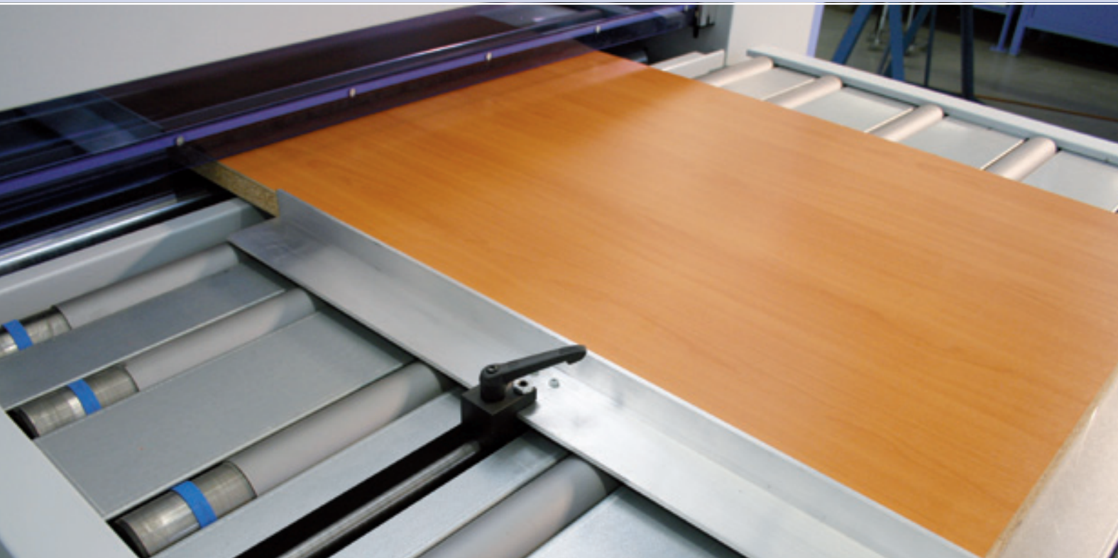
Anschlaglineal zur genauen Positionierung der Werkstücke auf der Maschine für ein exaktes Bearbeitungsergebnis
