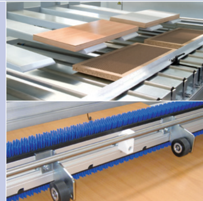
Bild oben: Motorisch verfahrbares Legeregal zum Lagern der Materialien und zur vereinfachten Positionierung der Werkstücke
