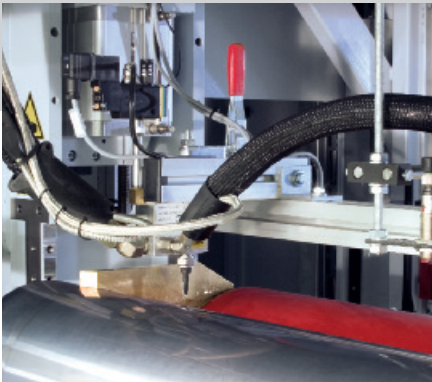
Automatische Klebstoffzuführung durch Fassschmelzanlage
