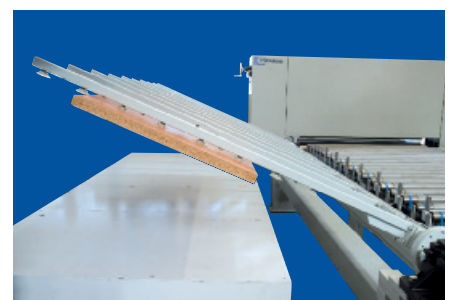
Wenden und Ab stapeln der Leichtbauplatten
