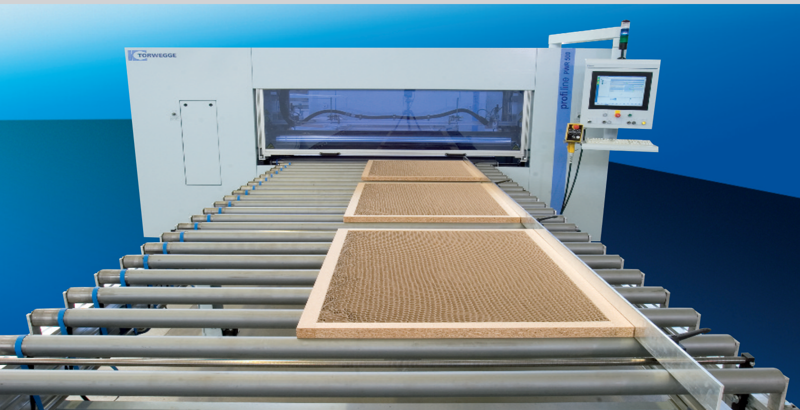
PWR 500 mit einseitigem Kleberauftrag in Ausführung 1.600 mm Breite
