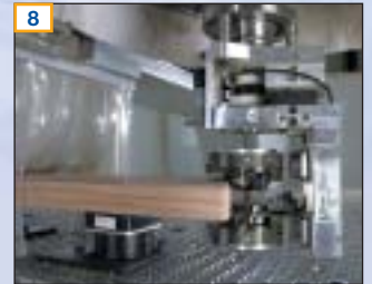
8 Interpolierende C-Achse 360°: um die Aggregate in beliebigem Winkel drehen zu können, inkl. Druckluftübertragung in die Aggregate (z. B. für getastete Aggregate)
