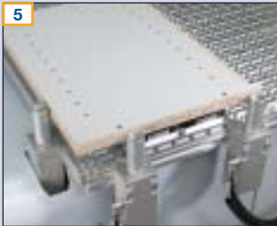
5 Anschlagbolzen zur einfachen und sicheren Positionierung von Werkstücken, auch bei der Pendelbearbeitung
