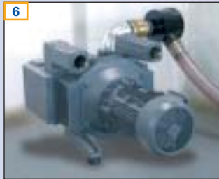
6 Vakuumpumpe mit 500 m 3 /h Leistung; 4 Zoll Leitungssystem in der Grundmaschine zur Übertragung von großen Vakuumströmen
