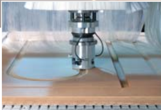
Fräsaggregat vertikal getastet für die hochpräzise Bearbeitung z. B. von Möbelfronten
