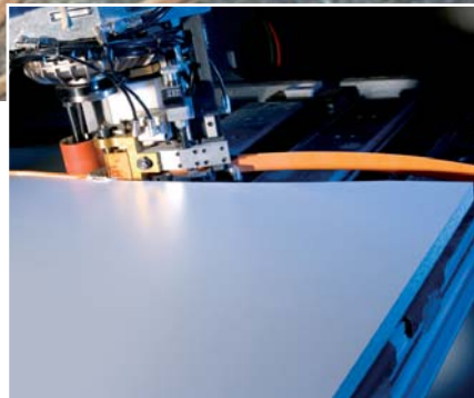
EasyEdge-Verleimaggregat für rationelles Kantenanleimen auch bei kleinen Losgrößen. Universell einsetzbar für: • ABS-Kanten • PVC-Kanten • Furnierkanten
