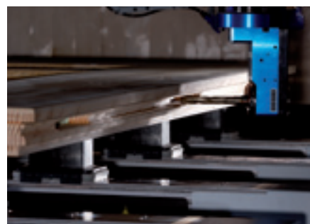
Fraisage d'un logement de serrure
