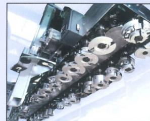
Schneller Kettenwechsler mit 30 großen Plätzen für Werkzeuge und Aggregate mit einem Durchmesser von bis zu 180 mm. Für Schlitz-/ Zapfenverbindung können auch größere Werkzeugdurchmesser eingesetzt werden
