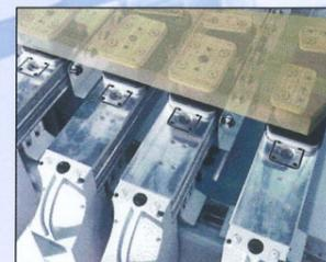
Arbeitstisch mit 7 oder 10 Konsolen und präzisen Linearführungen zur optimalen Werkstückspannung bei schwerer Zerspanung
