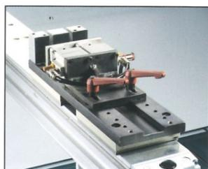
Konsolen mit verdeckten Zuleitungen von Druckluft für optimale Zugänglichkeit inkl. Schnellkupplungen zum Anschluss von Pneumatikspannern
