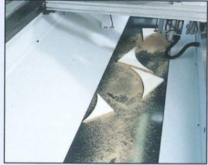
Hochsteifes Maschinenbett mit integrierter Reststückfassung über die gesamte Bearbeitungstiefe von 1.300 mm. Es fallen keine Reststücke vor die Maschine (optional mit Späntransportband)
