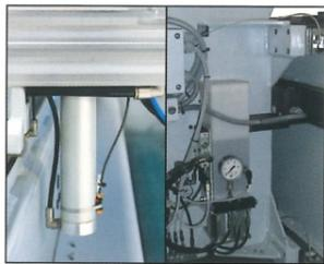
Anschlagbolzen mit Endlageüberwachung zum Schutz vor Beschädigungen von Werkzeugen und Aggregaten. Automatische Zentralschmierung für einen wartungsarmen, zuverlässigen Betrieb
