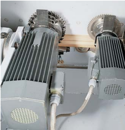
Ritzen, Zerspanen Vorformatieren des Plattenmaterials.
