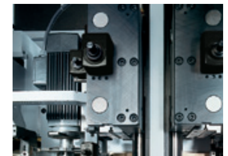
Postforming-Fräsaggregat-Formatteil Zum Fräsen des Gegenzugpapiers und des Laminatüberstandes.
