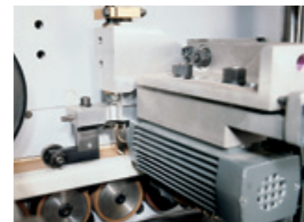
Fräsaggregat für V-Nut bei U-Profilen Zum Fräsen einer Ziernut in die Deckschicht oder zum Hinterfräsen bei aufgedoppelten Teilen.
