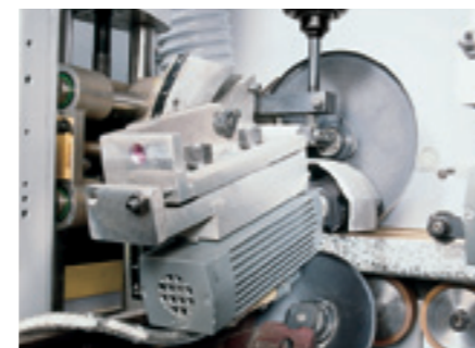
Fräsaggregat oben für L-Profile Zum Bündig- oder Fasefräsen des überstehenden Laminats.
