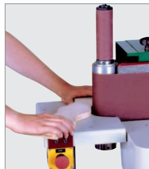
■ Durch den höhenverstellbarem Tisch wird das Schleifen über die gesamte Länge der Umlenkrolle und der Schleifhülse ermöglicht
