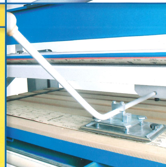
Suspended sanding pad ■ Abgefederter Schleifschuh ■ Patin abrasif et détendue
