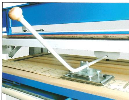
Brusná odpružená patka ■ Abgefederter Schleifschuh ■ Поддрессоренная шлифовальная пятка
