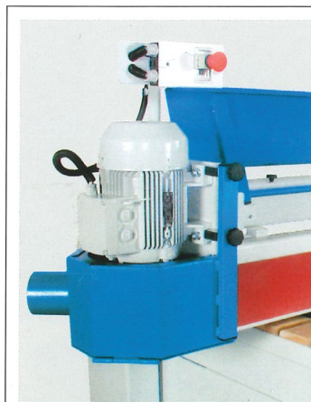
Sklopení brusného agregátu na 90° pro broušení hran ■ Schwenken des Schleifaggregates auf 90° für die Kantenschleifung ■ Поворот шлифовального агрегата на 90° для шлифовки граней
