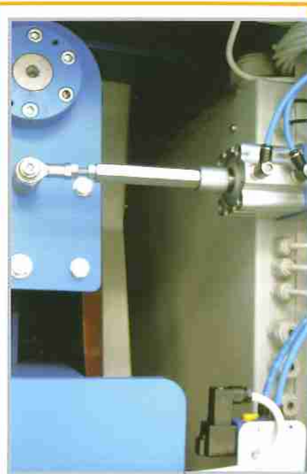
Pneumatická oscilace ovládaná IR čidlem Pneumatic belt oscillation with IR sensor Pneumatische Schleifbandoszilation mit IR Sensor
