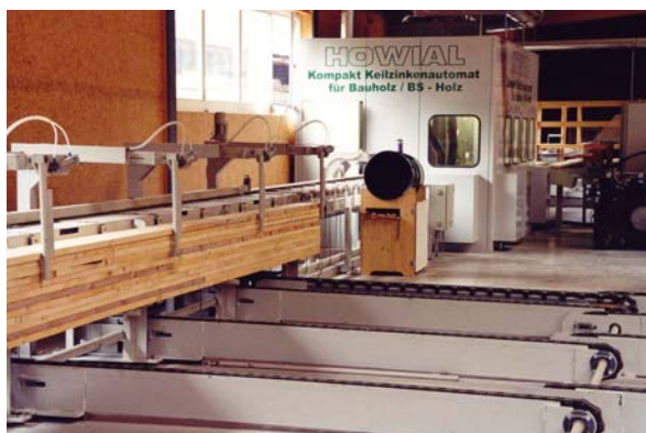
Production de bois de charpentes sur automate d'aboutages d'aboutages Kompakt HVP-25 avec zone tampon de séchage avant rabotage
