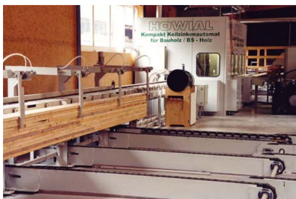
KVH-Produktion mit Kompakt-Keilzinkenautomat HVP-25 und Trockenpuffer zur Hobelmaschine
