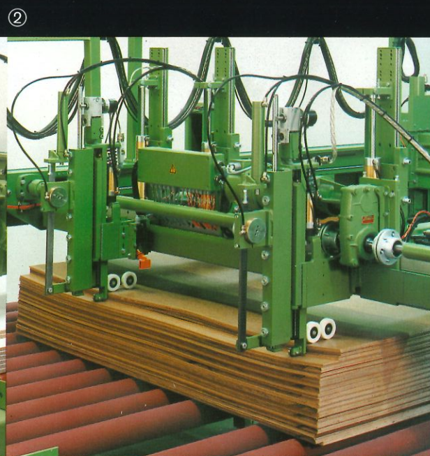
② Elektronische Mikroeinschubvorrichtung speziell für dünne, wellige Platten Electronic micro-infeed specially for thin, wavy panels Micro-alimentateur électronique, spécialement pour des panneaux minces ou ondulés Micro-alimentador electrónico, especialmente para tableros delgados u ondulados
