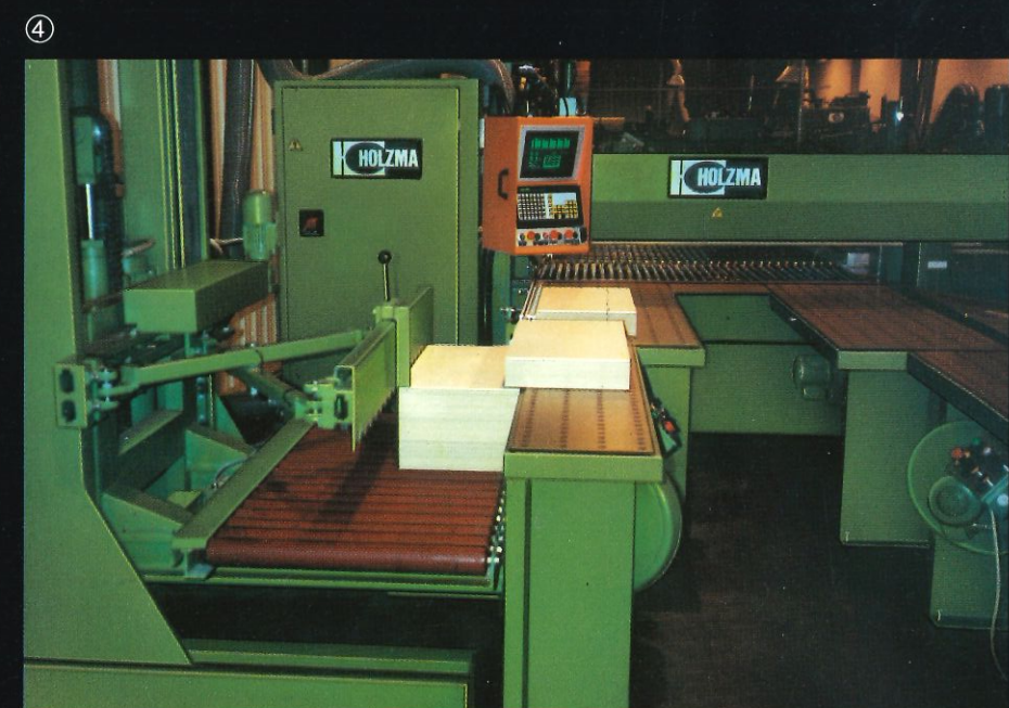
④ Abstapelung über Luftkissentische und HOLZMA Liftomat Stapelstation Destacking via air floatation tables and HOLZMA Liftomat destacking unit Empilage par tables à coussin d'air et station d'empilage HOLZMA Liftomat Apilamiento por mesas con colchón de aire y por estación de apilamiento HOLZMA Liftomat
