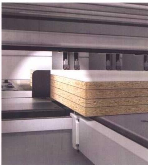
Zentrale Winkelandruckvorrichtung mit stufenlos einstellbarem Druck. Drückt direkt im Schnittspalt, genau dort, wo der Druck erforderlich ist.
