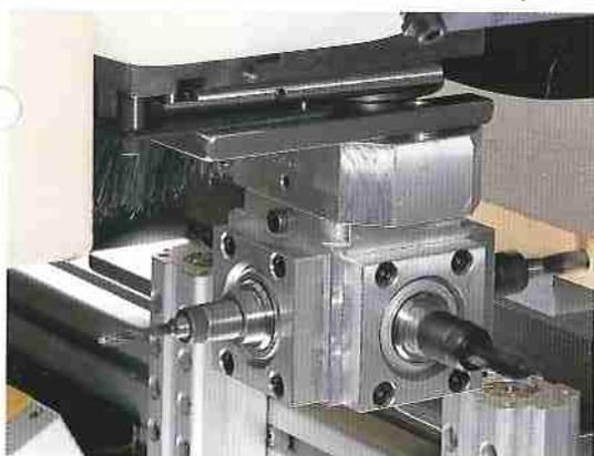
Das 4-spindelige Horizontal-Bohrgetriebe ist über den gesamten Arbeitsbereich einsetzbar: Auch in eine 2.600 mm x 1.300 mm große Platte lassen sich noch Horizontalbohrungen einbringen.
