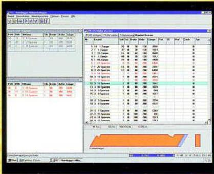
Die intelligente Mehrprozessor-Steuerung ermöglicht einen rationellen Arbeitsablauf ohne Holz-Vorsortierung. Kanthölzer werden in der Reihenfolge, in der sie auf dem Beschickungs-Querförderer liegen, aus der Holzliste abgerufen, von der Maschine automatisch abgearbeitet und aus der Holzliste abgebucht.
