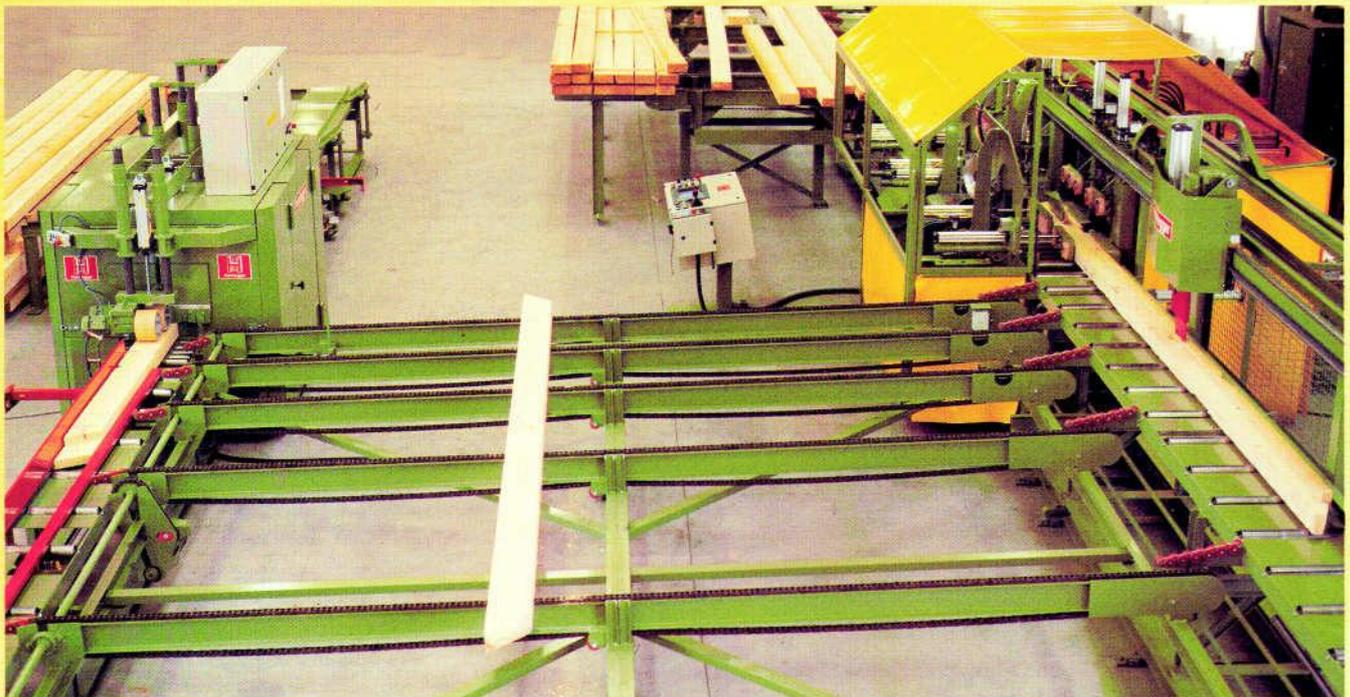
Durch überlappende Fertigung mit Vorpositionierung und parallellaufende Abbund- und Hobelmaschinenanordnung sind 4 Hölzer gleichzeitig im Durchlauf.
