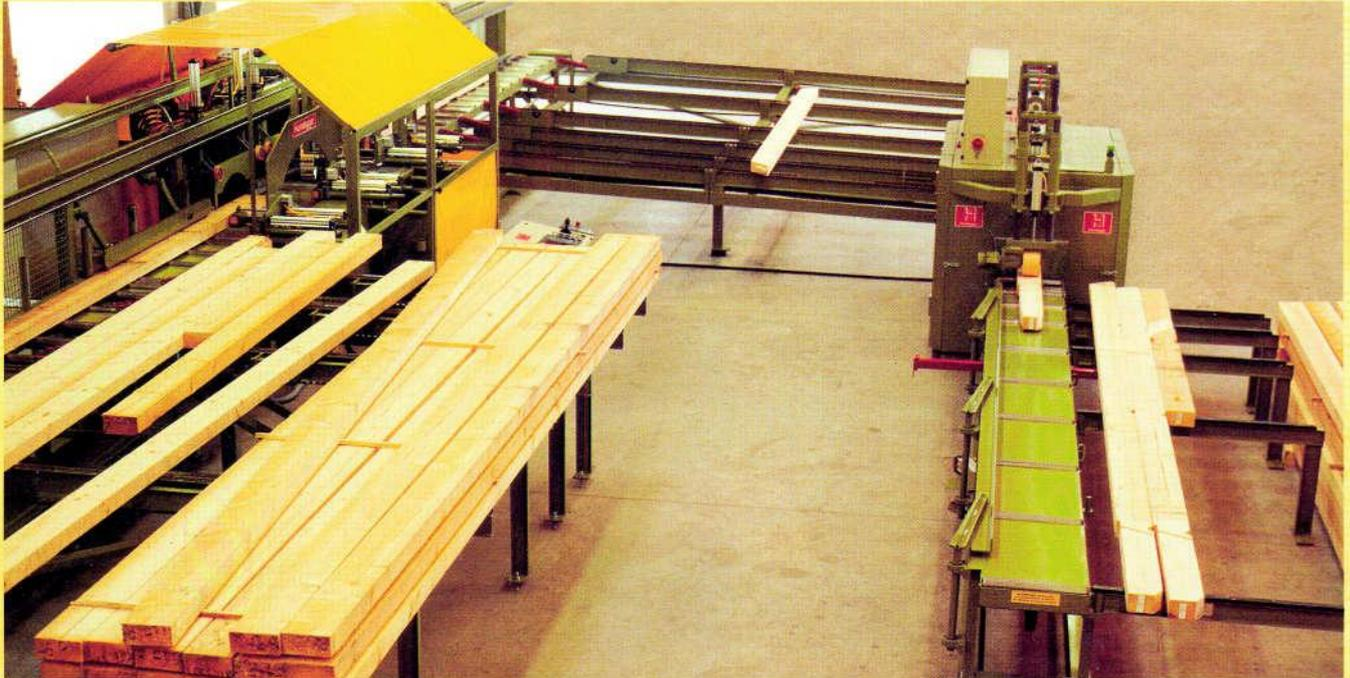
**Abbundmaschine mit integriertem Vierseitenhobel- und Fasautomat**
