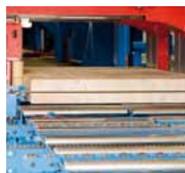
Шлицепорезное приспособление ведется до 1250 мм
