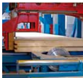
Фрезерование до 1250 мм
