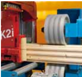
Профильная фреза для заготовок бревенчатых домов
