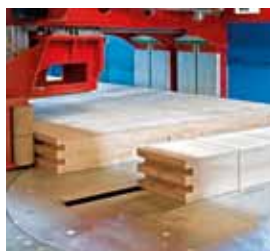
Разрезы пилой до 1250 мм
