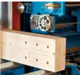
Любые схемы сверления: горизонтальные и вертикальные
