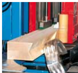
Выполнение пазов или сглаживание неровностей без отходов древесины
