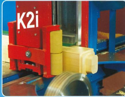
Le bois est directement pressé au niveau de la zone d'usinage.
