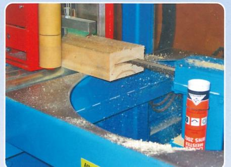
**L'appareil pivotant pour fentes en chaînette vous permettra par exemple d'usiner facilement des fentes masquées ou en angle.**
