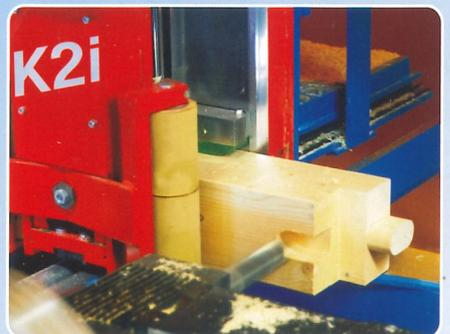
**Les liaisons spéciales peuvent être enregistrées sous forme de groupe d'usinage.**
