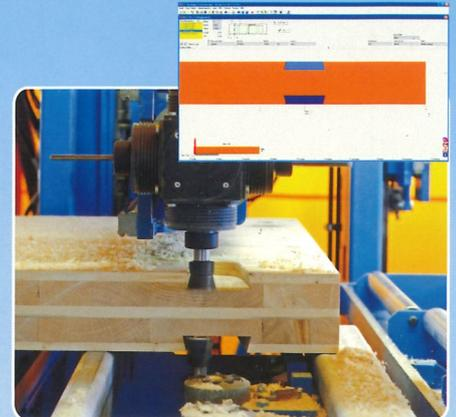
Avec la fraise revolver horizontale et la défonceuse verticale on pourra réaliser deux usinages identiques simultanément.
