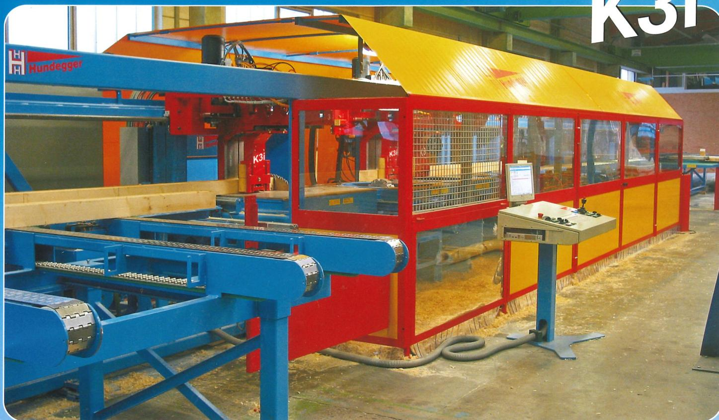
La variante haute vitesse K3i a été développée afin de pouvoir continuer à accroître encore la vitesse d'usinage de la K2i, principalement pour les grandes industries (maisons bois, taillage).
