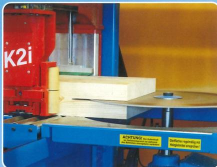
*La scie horizontale permet d'autre part de réaliser rapidement et proprement des fentes d'une profondeur maximum de 350 mm.*
