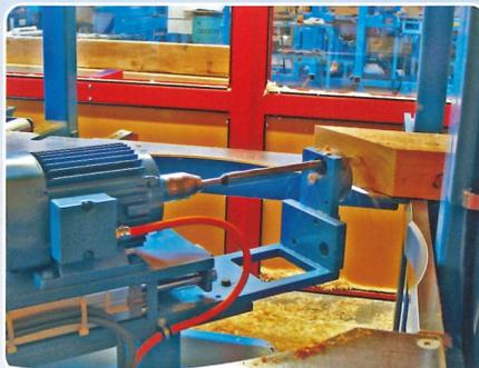
**Nouvelle perceuse pivotant à 360°. Il est possible de réaliser des perçages sur tous les côtés à usiner.**
