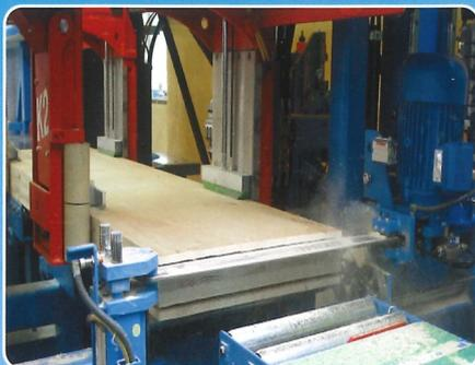
*Cet appareil permet en effet d'effectuer rapidement et précisément des fentes masquées sur la surface d'arrêt ainsi que des fentes d'une longueur quelconque sur des pièces d'une largeur maximale de 1250 mm.*
