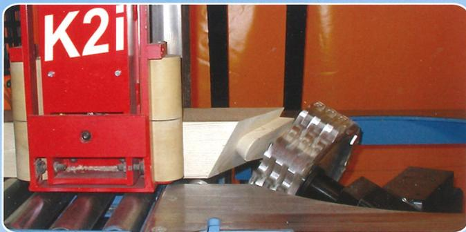
*La fraiseuse à 5 axes sur le lincau permet de monter précisément sur chaque angle et sur chaque déclivité des raccords coniques en queue d'aronde.*
