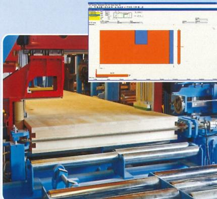
Tronçonneuse guidée jusqu'à une profondeur de 1250 mm. Réalise également des entailles non débouchantes.
