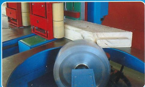
Le nouveau système révolutionnaire de positionnement à deux chariots à griffes et de guidage assure une grande précision, même pour du bois gauchi ou tordu. Le bois est pressé uniquement au niveau de la zone d'usinage, afin que son gauchissement et sa torsion n'influent pas sur la précision d'usinage (voir ébauche).
