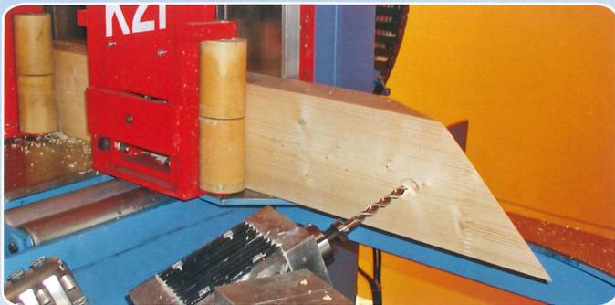
*Perçages sur 5 faces de la pièce avec un angle et une inclinaison variable.*
