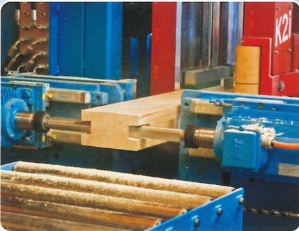
**Avec le double support horizontal on pourra effectuer tous types de perçages et fraisages sans éclats, simultanément sur deux faces. Le temps de cycle est raccourci très sensiblement.**
