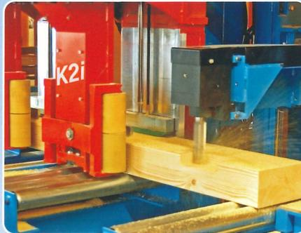
**La défonceuse du haut peut également être équipée avec une fraise à queue d'aronde.**
