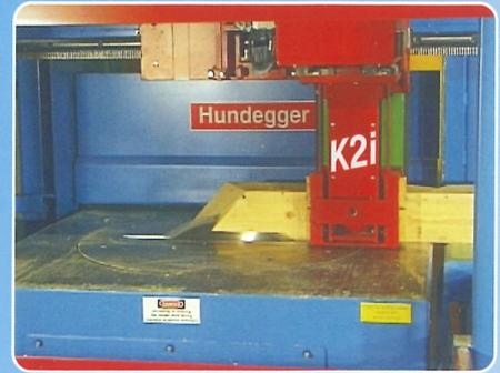
**Cannelures ou coupes de noue entièrement automatiques, au millimètre près.**
