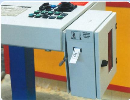
*Imprimante d'étiquettes sur pupitre indiquant la dénomination de l'élément de construction, le numéro de l'élément de construction etc..*
