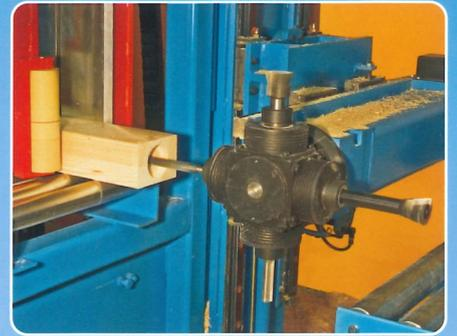
**Fraise Revolver. Montage jusqu'à 5 outils, comme perceuse, défonceuse, fraise universelle ou fraise à queue d'aronde.**
