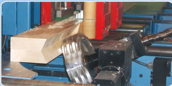
*La nouvelle fraiseuse à 5 axes pour la K2 présente de nombreux autres avantages tels que des cannelures ou des bavures sans résidu de bois.*
