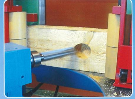
Logement pour disques, écrous, chevilles à clavette annulaire etc.
