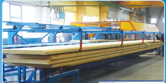
Table de levage hydraulique avec défilage automatique des pièces.
