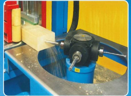
**Fraise Revolver. Montage jusqu'à 4 outils, comme perceuse, défonceuse, fraise universelle ou fraise à queue d'aronde.**
