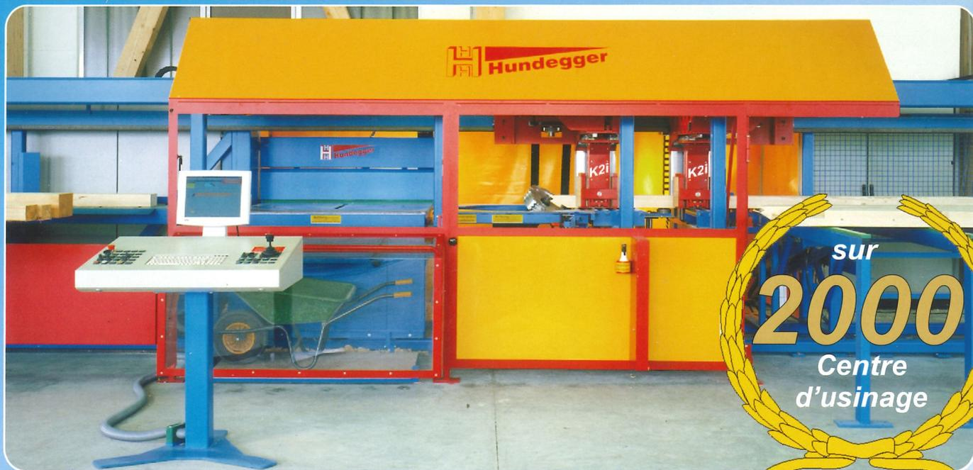
**Usiner le bois de construction sans mesures, sans ébauches et sans temps de démarrage préalables. Section réglable de 20 mm x 50 mm à 300 mm x 450 mm. (Option 625 / 900 / 240 x 1250 mm)**
