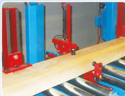
*Système de mesure de section automatique pour la reconnaissance et la correction de la section du bois brut.*
