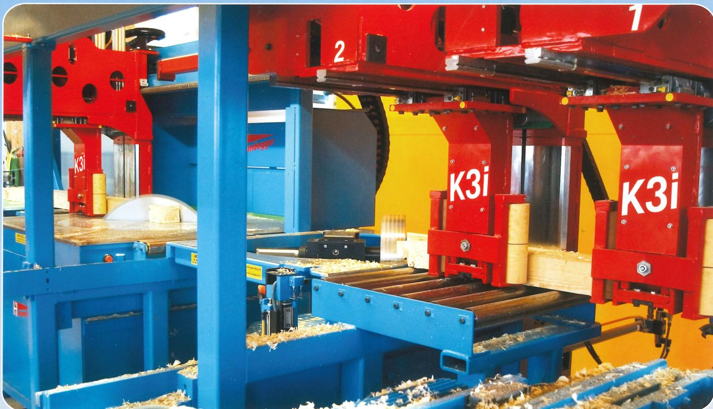
Dans cette variante de machine, et pendant l'usinage d'une première pièce dans la zone machine, le troisième wagon positionne déjà la pièce de bois suivante sur la scie, afin de procéder immédiatement aux premières coupes de scie sur celle-ci. Avec les autres aggrégats supplémentaires comme par exemple le double support horizontal, développé dernièrement ou un système par Jet d'encre indépendant, on peut arriver à diviser le temps d'usinage par deux.
