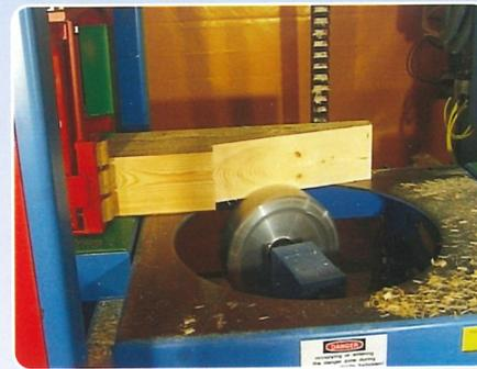
Aponce gerber, réalisée par la fraise universelle.
