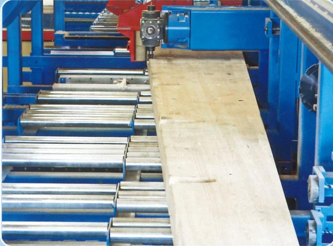
Les poutres en lamellé coniques jusqu'à 5° peuvent être usinées sur toutes les faces de la pièce sans modification de la machine.
