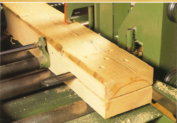
Kettenstemmer horizontal – Knotenblechschlitzung –
