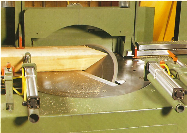
Hydraulische Untertischschwenkkappsäge – Schifterschnitt –
