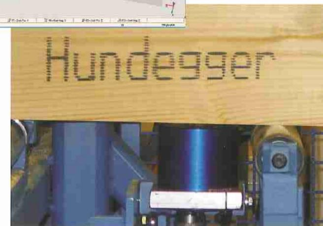
Le système d'écriture à jet d'encre permet l'écriture sur les pièces (hauteur des caractères de 13 à 67 mm en une ou deux lignes). Un dispositif de marquage sert au traçage des pièces (en option).
