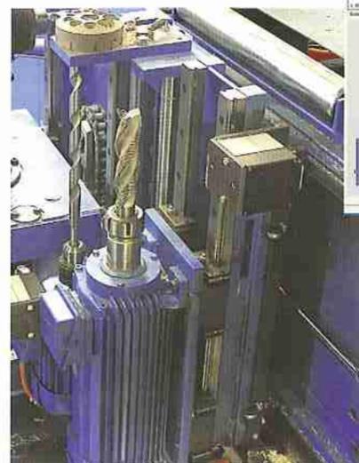
Avec la fraise verticale (qui peut être équipée de divers outils), vous réalisez des rainures, des mortaises, des profils de toute sorte, etc. Les perceuses à rajouter à tout moment, permettent la réalisation de toutes sortes de perçages (par ex. perçages borgnes)..
