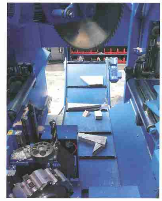
Die Entsorgung der Abschnitte erfolgt mit einem in die Maschine integriertem Förderband nach hinten.
