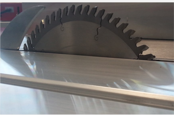
Sägeaggragat, max. Sägeblattdurchmesser 315 mm
