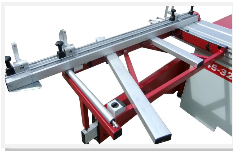
Großflächiger Tischausleger 1200 x 600 mm (verschiebbar) mit Materialrolle, Winkel- und Gehrungsanschlag (ausziehbar bis 3400 mm)
