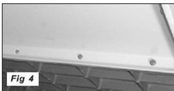
3. Befestigen Sie die Tischverbreiterung „Blechteil“ mit der Gussteilverbreiterung. (Fig.4). Den Abgleich der Platten und das Anziehen der Schrauben führen Sie bitte wie in Pkt. 2. beschrieben durch
