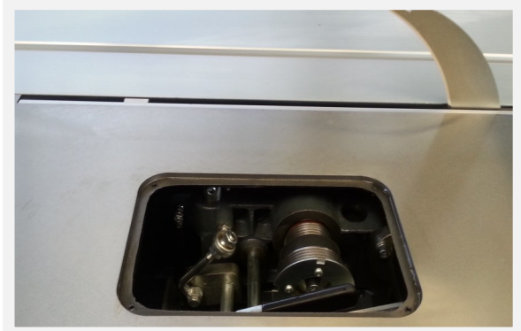
Tischöffnung 250 x 150 mm für schnellen und einfachen Drehzahlwechsel
