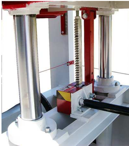
Präzisions Zahnstangen Parallelführung für Gleichlauf des Drucktisches
