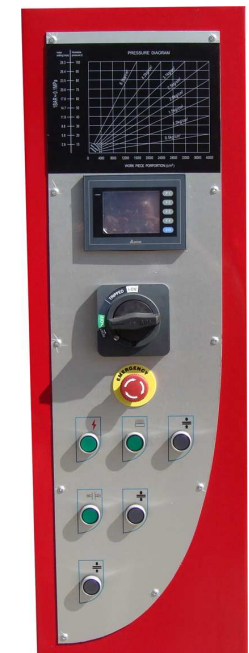
SIEMENS SPS Steuerung mit bedienfreundlicher Touchscreen Bedienung
