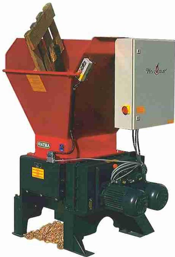
**Heizomat-Zerkleinerungsmaschinen** verarbeiten die betrieblichen Abfälle wie Holzabschnitte - Spreißel - Paletten - Kantstücke - Latten - Kartonagen usw. zu hochwertigem Brennmaterial für die automatische Verfeuerung.
