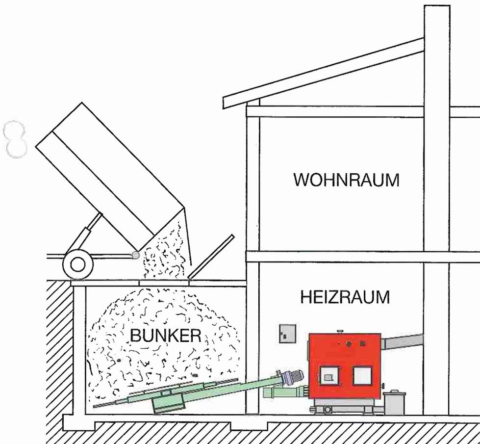
Am Ende der Austragungsschnecke fällt das Brennmaterial über einen Fallschacht auf die darunterliegende Einschubschnecke. Der Fallschacht kann bei Bedarf verlängert werden. Im Fallschacht ist eine Zellenrad-schleuse eingebaut, die eine ständige mechanische Unterbrechung zwischen Brennstofflager und Feuerung gewährleistet.
