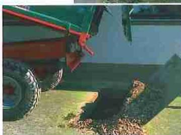
**HEIZOMAT- Mobile Hackmaschinen** können mit hoher Durchsatzleistung Astholz - Durchforstung - Hecken - Sträucher - Sägeschwarten - Spreißel - Rebholz - Kantstücke - Spaltholz -, ja ganze Bäume zu gleichmäßigen Hackschnitzeln verarbeiten.
