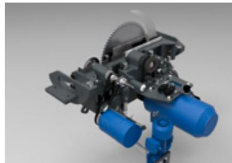
Eigener Motor für das Vorritzaggregat.
