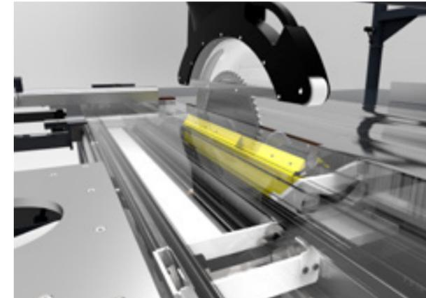
Stabile Führung des Schiebetisches an den 4 Stahlstangen mit einer Härte von 60 HRC. Aufgrund des vergrößerten Durchmessers der Stahlrollen läuft der Schiebetisch ruhig.
