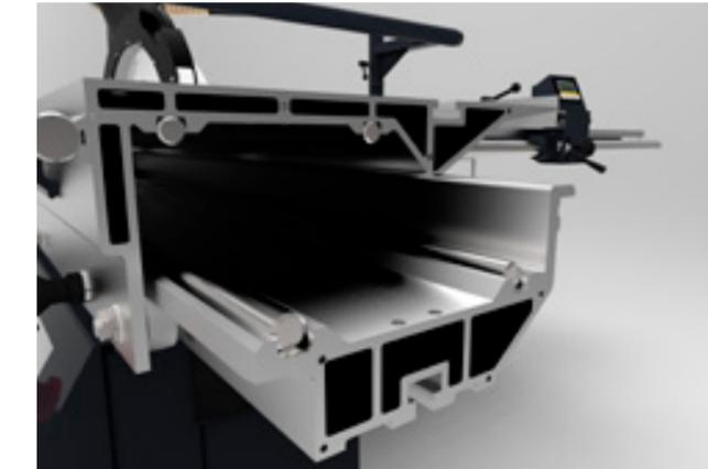
416 mm breites Mehrkammer-Aluminiumprofil mit 4 Stahlrollen und 12 Exzenterrollen.
