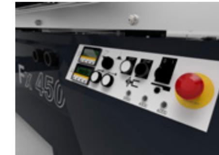
Digitale Anzeige der Sägeblattschwenkung (Standard) und digitale Anzeige der Höhenverstellung (optional).
