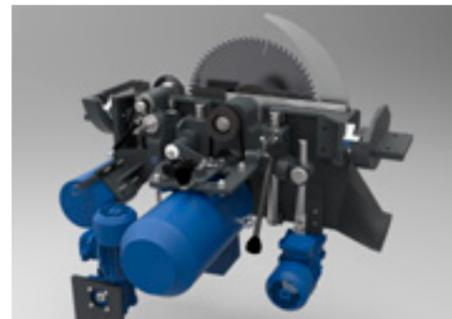
Gussaggregat mit Höhenverstellung und Schwenkung.
