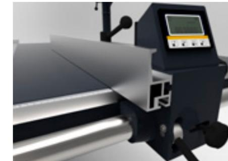
Digitalanzeige am Parallelanschlags mit Speicherfunktion (optional).
