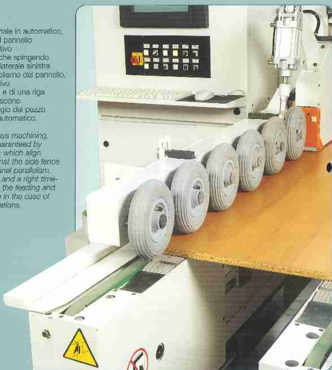
Nella lavorazione trasversale in automatico, un sofisticato sistema di centraggio garantisce sempre l'allineamento del pezzo rispetto alla linea di lavoro.
