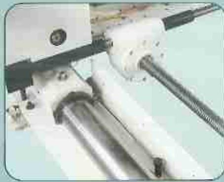
Costituito da maglie in materiale sinterizzato, il **cingolo** scorre su guida rotonda e piana mediante cuscinetti lubrificati che consentono di ridurre al minimo l'attrito, e di ottenere un'elevata precisione e rettilinearità di avanzamento.
