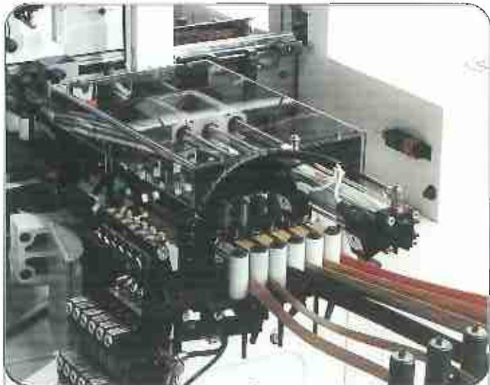
**Lo scambiatore automatico a pinze** permette di cambiare il bordo in lavorazione riducendo al minimo i tempi di cambio di lavorazione e garantendo un'ottima precisione nel posizionamento del bordo.
