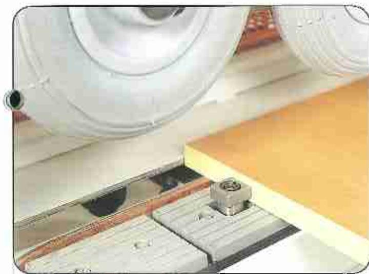
Il pannello viene trascinato in macchina da una coppia di pioli ad intervento automatico e regolabili in altezza in modo da ottimizzare la fase di trascinamento in funzione dello spessore del pannello.
