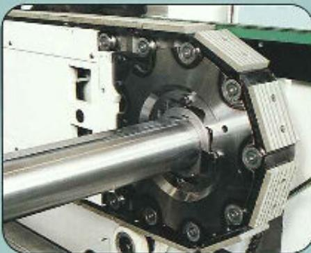
Das **Kettenrad** ist mit 9 Zähnen versehen, die eine konstante Vorschubbewegung sicherstellen und eine Längung der Kette verhindern. Die gehärteten und geschliffenen Lageraufnahmen sorgen für geringeren Verschleiß und sichern lange Lebensdauer und hohe Präzision.
