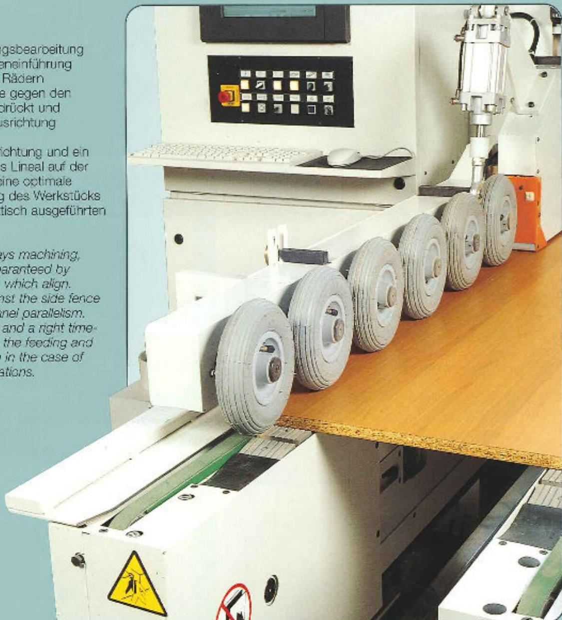
Bei der automatischen Querbearbeitung sorgt ein ausgeklügeltes Zentriersystem dafür, daß das Werkstück stets perfekt zur Arbeitslinie ausgerichtet ist. Eine Riemen-Transportvorrichtung stellt zusammen mit einem Haken-Zentrierer und einem Sprossen-Ausrichter eine optimale Aufgabe und Zentrierung des Werkstücks sicher. Die perfekte Synchronisierung der Zentriervorrichtungen garantiert ein präzises Formatieren der Platte und sorgt für einwandfreie Rechtwinkligkeit der bearbeiteten Flächen.
