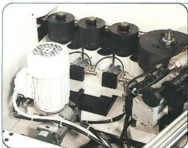
Durch verschiedene Zubehörteile kann das Anleimaggregat für spezielle Bearbeitungen, wie das Anleimen von Furnierstreifen oder Einsetzen der Staubschutzkante ausgelegt werden. Ferner ist das Anleimsystem für PU-Lam erhältlich, wenn eine wasser- und hitzebeständige Kante verlangt wird.
