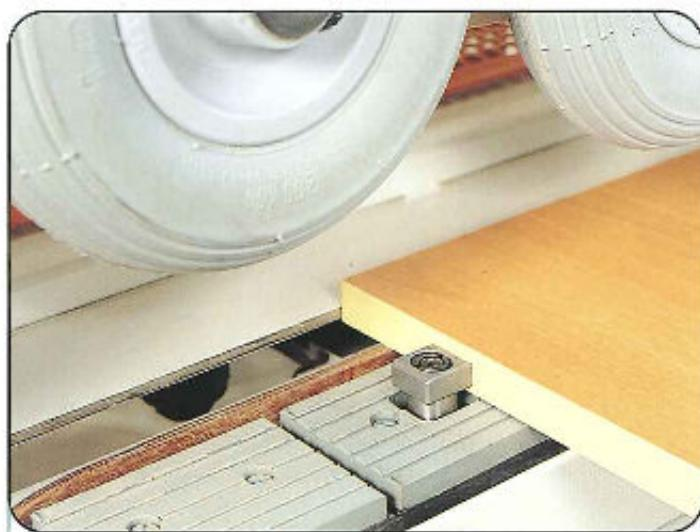
Die Platte wird von einem einsatzgesteuerten Sprossenpaar in die Maschine transportiert; die Sprossen sind höhenverstellbar, um so den Transport optimal auf die Plattendicke abzustimmen.
