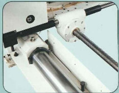
**Beweglicher Ständer** Für eine stets perfekt parallele Ausrichtung wird der bewegliche Ständer steif über einen hochpräzisen Schneckenantrieb ausgefahren.
