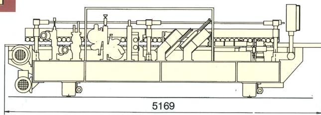
Macchina conformabile alle esigenze del cliente, prevista nelle tre versioni: per lavorare bordi fino a 5 mm., a 12 mm. e 20 mm.; e può montare, a seconda delle versioni, fino ad un massimo di quattro gruppi dopo quello intestatore.
