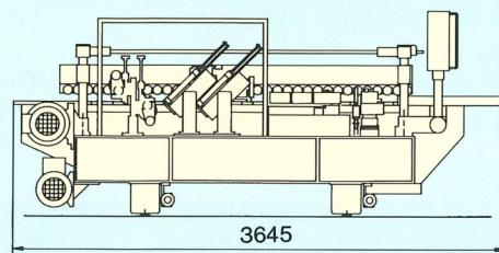
Macchina estremamente compatta per lavorare bordi fino a 5 mm. di spessore, composta da incollatore, intestatore e refilatore multifunzione.
