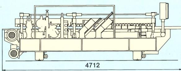
Macchina conformabile alle esigenze specifiche del cliente. Essa è prevista nelle tre versioni: per lavorare bordi fino a 5 mm., fino a 12 mm. e 20 mm.; e può montare, a seconda delle versioni, fino ad un massimo di tre gruppi dopo quello intestatore.
