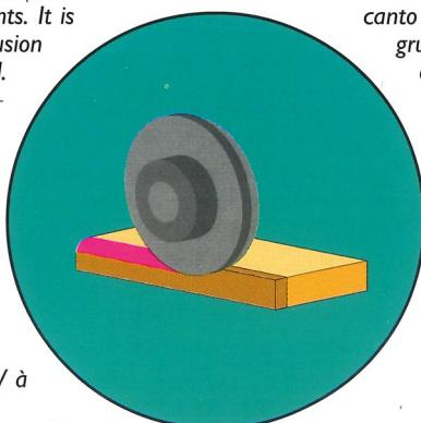
Grupo dotado de N°2 motores de 0,2 KW a 12.000 rpm. (200 Hz), de 2 utensilios de diámetro 70 mm. x 20 mm. x 20 mm., tiene 6 aristas de corte ; posibilidad de dotarlo de exclusores neumáticos mandados por un selector colocado en el panel de mando.
