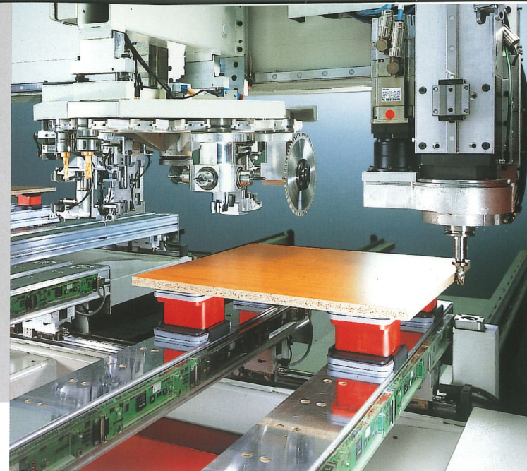
18-fach Werkzeugwechsler und Hauptspindel
