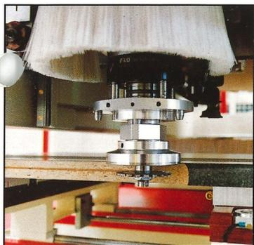
Adapteraggregat, Horizontalnuten, tastend, CNC-gesteuert, 360°, max. 5 mm Tastweg, Drehzahl max. 9000 U<sub>p</sub>M.
